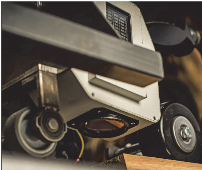
Figura 5 – O scanner do Espectroscópio de Infravermelho Próximo analisa a madeira com um filtro ótico-acústico calibrado, resultando numa correlação matemática para os diferentes níveis de tanino, aduela a aduela (Foto: Jean-Luc Pineau).
