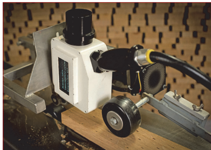
Figura 1 – Quantificação do tanino potencial (TP) por espectroscopia de infravermelho próximo (FT-NIR) ao longo de aduelas de carvalho-francês não tostadas (Foto: Jean-Luc Pineau).
