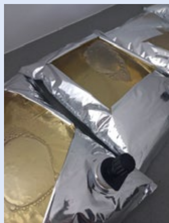
Figura 1: El espacio de cabeza varía significativamente de un BiB a otro. Esto da como resultado una alta variabilidad en la calidad y vida útil del vino dentro del mismo lote.
